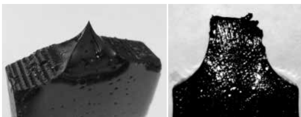
Figura 2. Muestras de DENT mostrando (Izq.) una zona plástica elíptica llevada a fallar sin que el cemento asfáltico se desgarre en una línea recta, y (Der.) una falla dúctil con significativa elasticidad y un ligamento desgarrado para un ligante de un polímero modificado.
